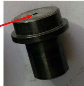
Dans le cas d'une usure avec une pointe au bout de la tige le problème vient de la butée d'embrayage qui est percée (voir photos ci-dessus).
