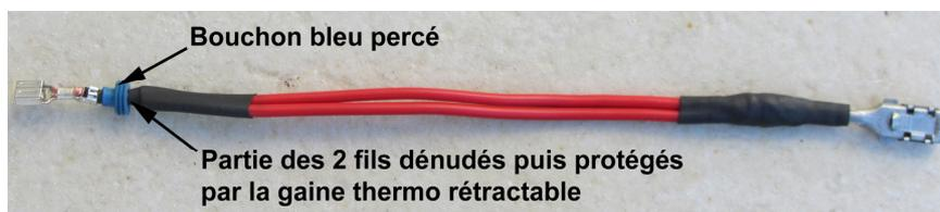
Le changement de ces fils implique également soit de faire une soudure pour les rallonger simplement soit d'ouvrir la cosse du support du maxi fusible si on préfère avoir un fil continu, c'est ce que j'ai préféré faire. Ci-dessous la façon de démonter la cosse du support du maxi fusible.
