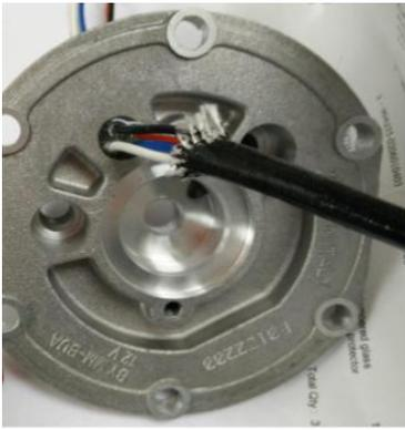
**2)** Enfoncez le passe câble par le dessus du flasque (intérieur réservoir) en butée. L'enduire d'un produit d'étanchéité avant la pose, il se mettra ainsi plus facilement en place.
