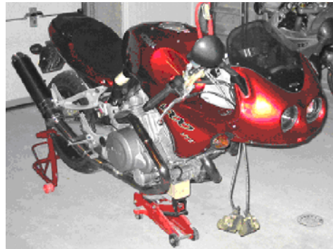
Calage de la moto sous le démarreur, moto sur une béquille d'atelier
