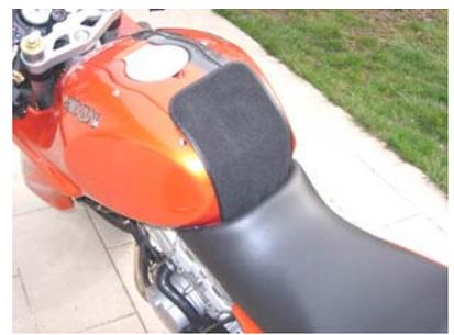
Installation du Tapis: Fixation facile du tapis par une sangle autour de la colonne de direction. Le tapis fait lecteur de cartes. Il s'ajuste sur le support par velcro.
