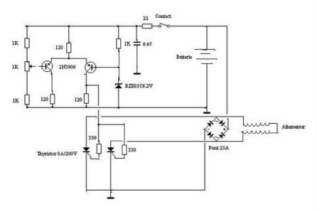
(c'est un schéma de principe, celui-ci n'est pas forcément identique au régulateur des voxan)
