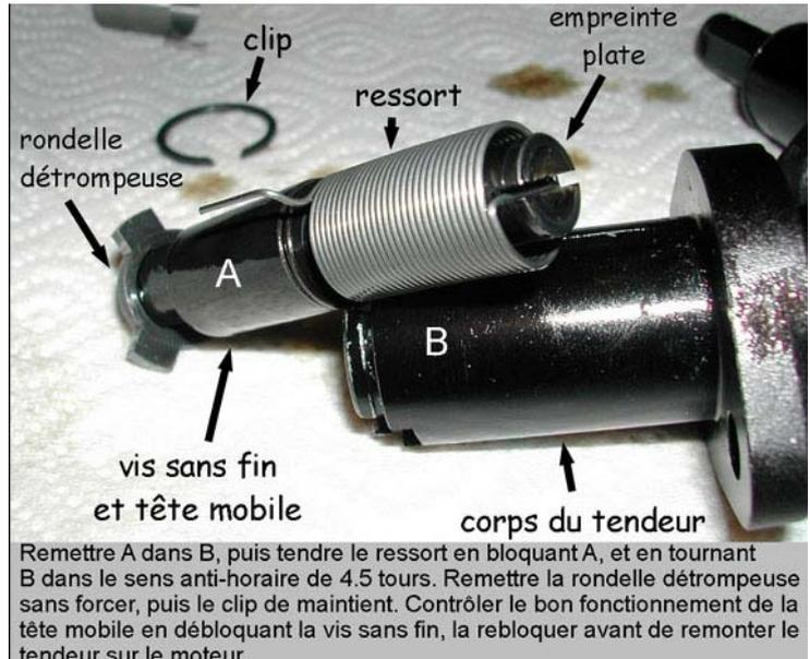
Remette A dans B, puis tendre le ressort en bloquant A, et en tournant B dans le sens anti-horaire de 4.5 tours. Remette la rondelle détrompeuse sans forcer, puis le clip de maintient. Contrôler le bon fonctionnement de la tête mobile en débloquant la vis sans fin, la rebloquer avant de remonter le tendeur sur le moteur.
