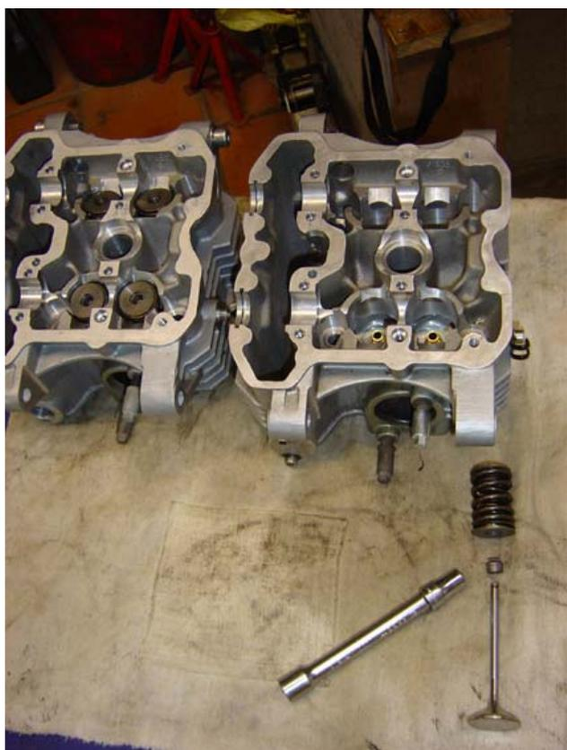
8-8 Mise en place joints de queues de soupapes (outils = douille au diamètre extérieur du joint)
