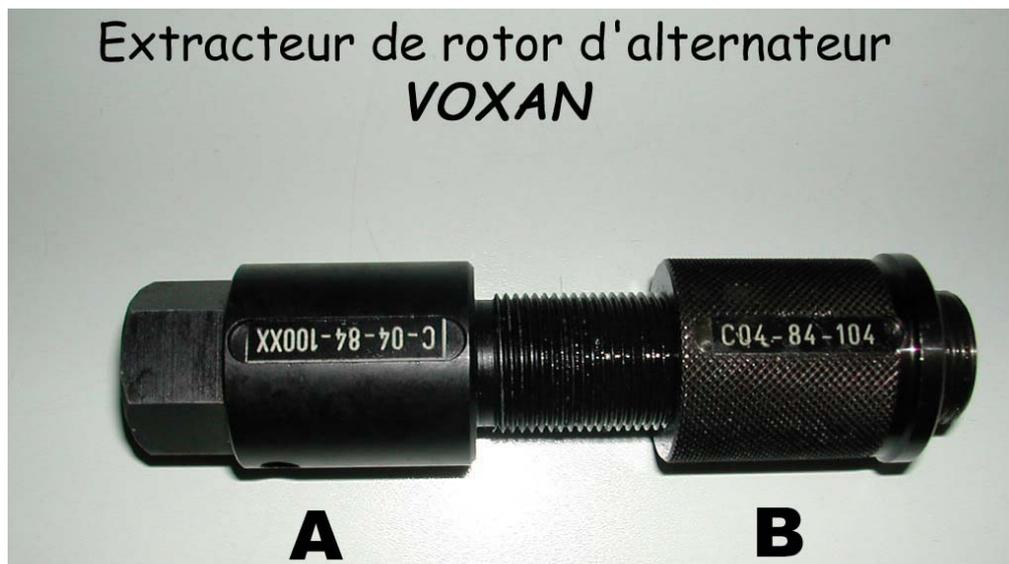
Visser la partie B sur le rotor à la main, au contact désserer de 1/4 de tour, puis visser la partie A en contact avec la queue de vilbrequin, serrer fort avec une douille de 24, le rotor se décolle.
