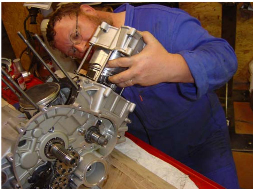
8-5 Mise en place cylindre / rentrée des segments
