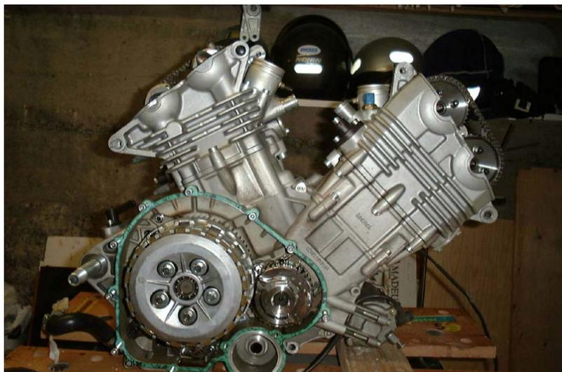
4-1 Côté du logement du filtre à huile, transmission primaire & embrayage couvercle ôté
