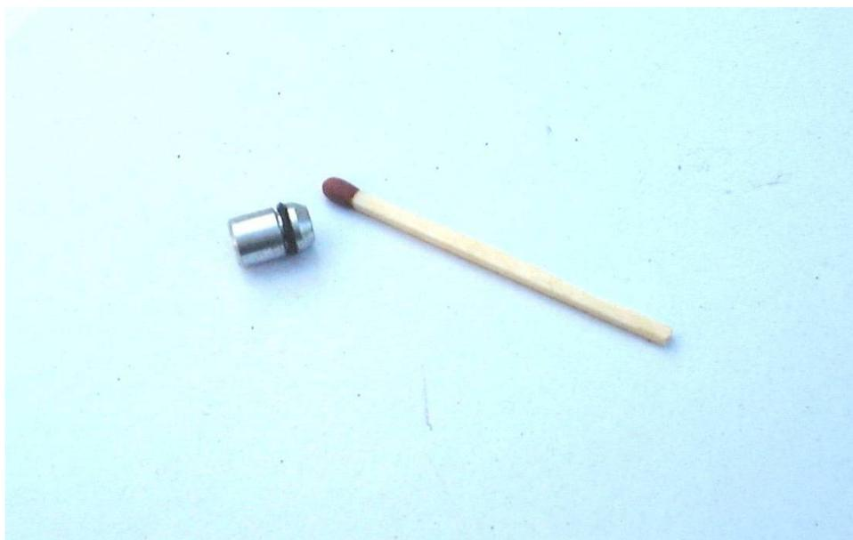
7-4 Gicleur de montée d'huile à placer sous le joint d'embase
