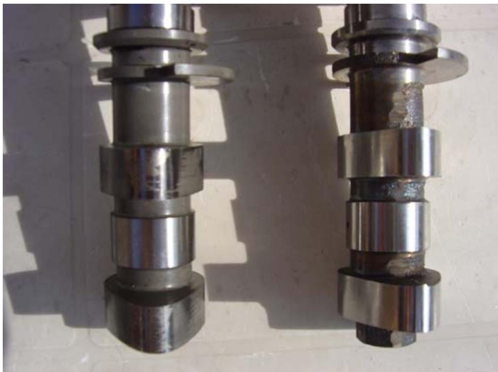
6-13 Usure arbre à came (le neuf à droite, le réformé à gauche)
