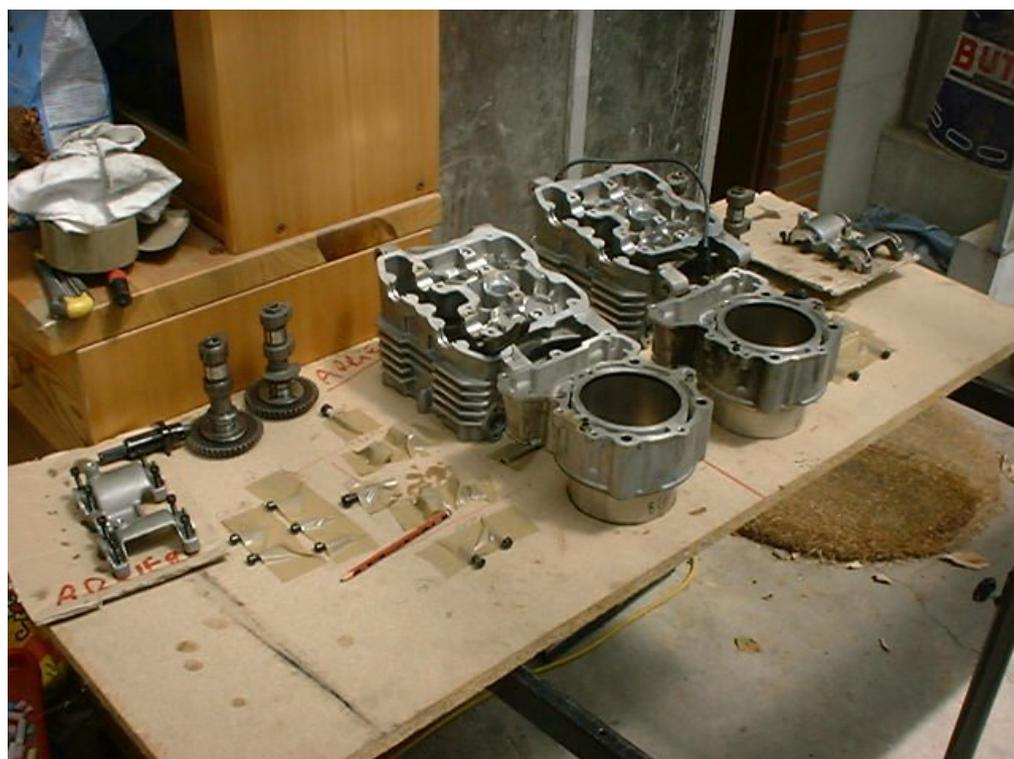
2-2 vue de la distribution démontée au niveau des culasses
