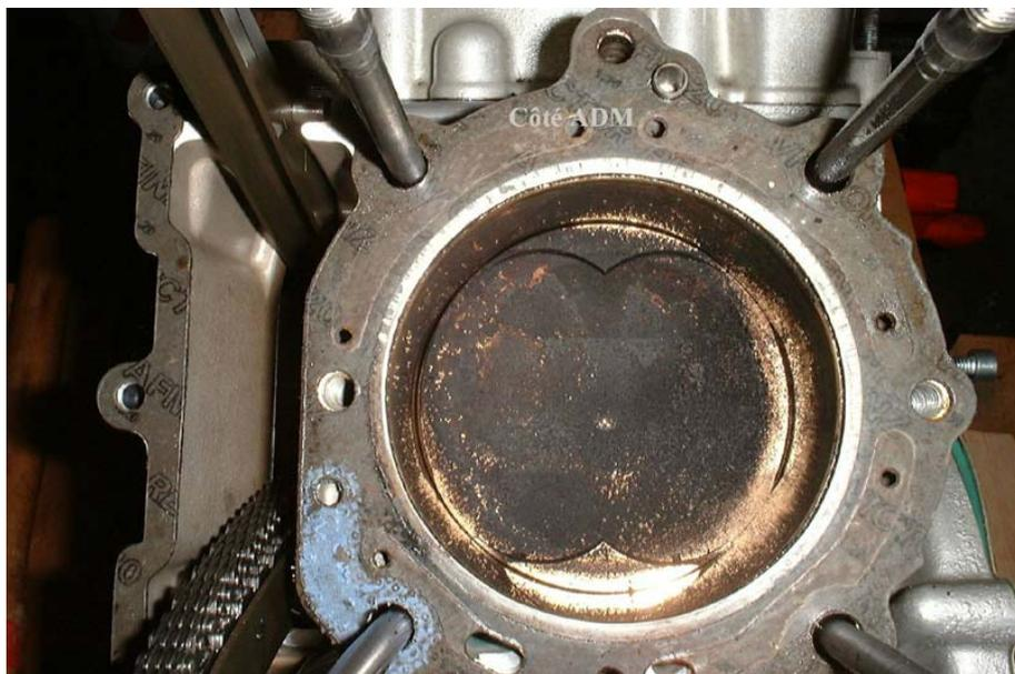
2-13- cylindre / piston avec ancien joint culasse
