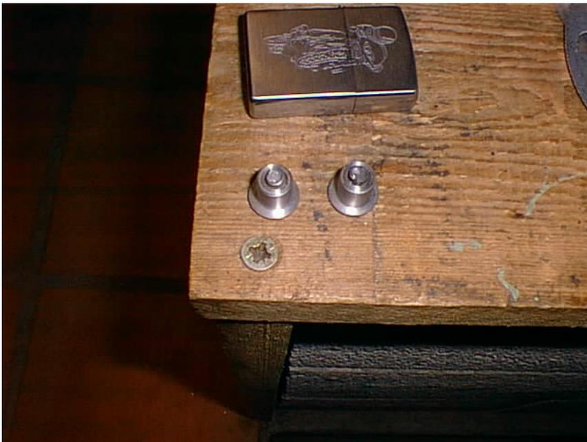
6-3 vis d'axe de rotation du patin mobile (vis spéciale qualité 8.8) : à surveiller car peut casser au remontage si serrage au couple prescrit (10Nm). Plutôt en mettre des neuves à 10Nm ou les anciennes à 8Nm au remontage bien contrôler la libre rotation du patin, sinon insérer une rondelle de clinquant (#0.2mm) sur la partie fileté de l'axe.
