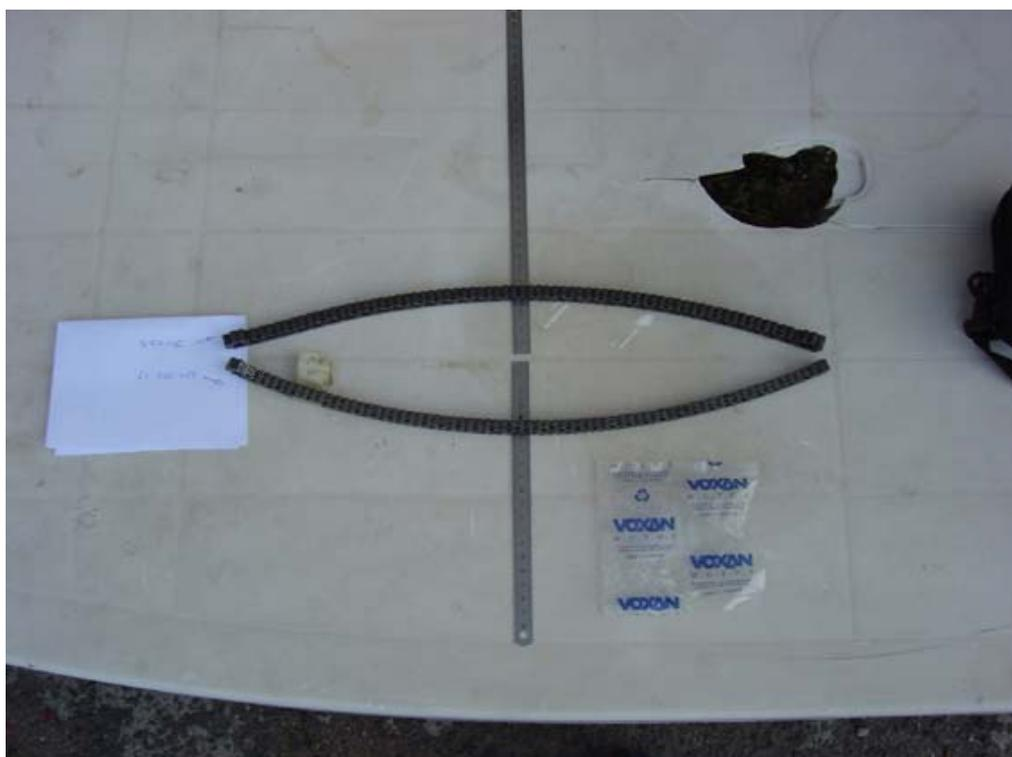
6-11 Mesure arc chaîne de distrib (en haut la neuve, en bas l'usée)
