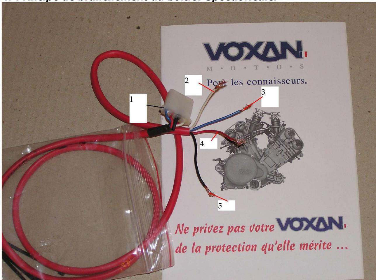
1 => connecteur qui se fixe sur le boîtier SpeedoHealer (noter la présence d'une pâte solide et transparente qui maintient les câbles à l'abri des vibrations et autre développement d'humidité). Le câble fait environ 80 cm. En kit Harness Universal, les fils sont fournis dénudés prêt à souder/visser
