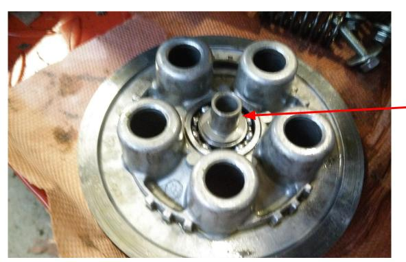
la butée remontée avec le roulement
