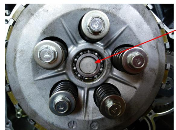
nouvelle butée non percée remontée avec un roulement neuf et tige neuve
