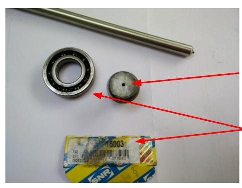
le coupable : la butée d'embrayage percée
