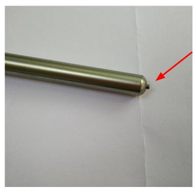
diagnostique : usure en pointe de la tige de commande
