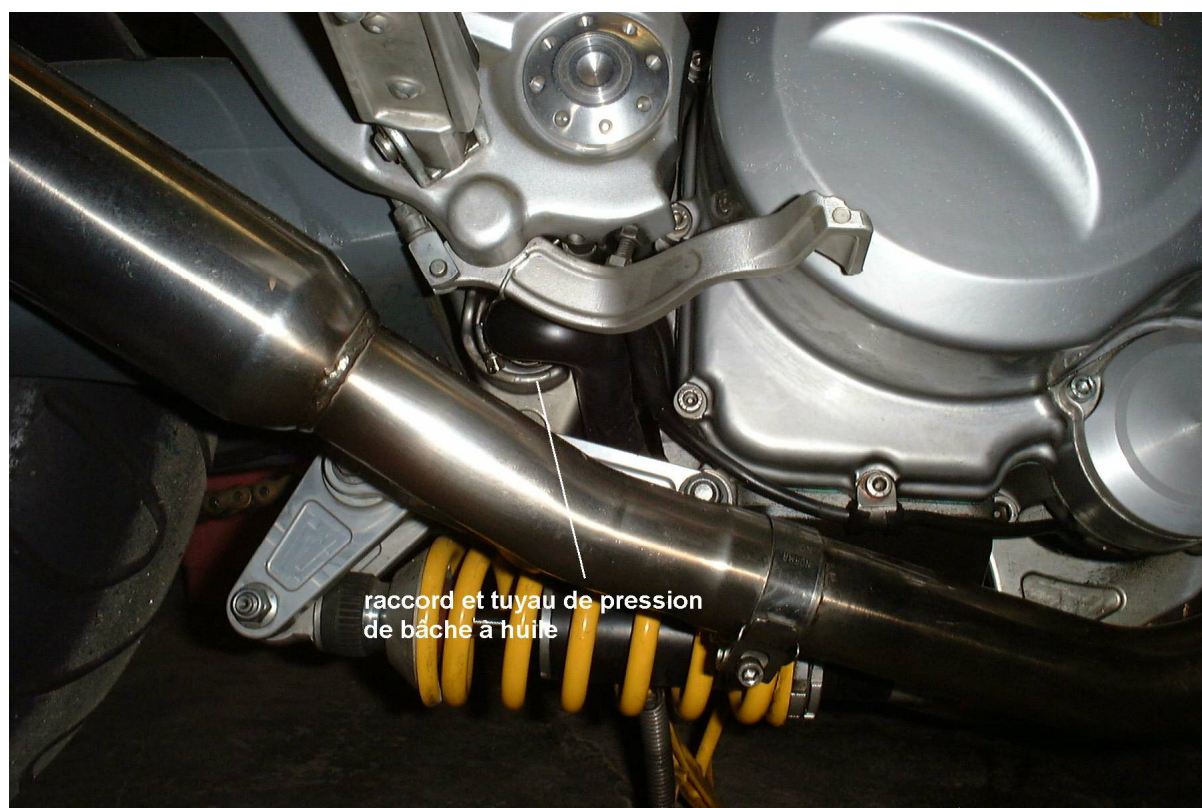
3-1 ôter le serflex du tuyau d'alim d'huile au moteur (sous cale-pied droit)
