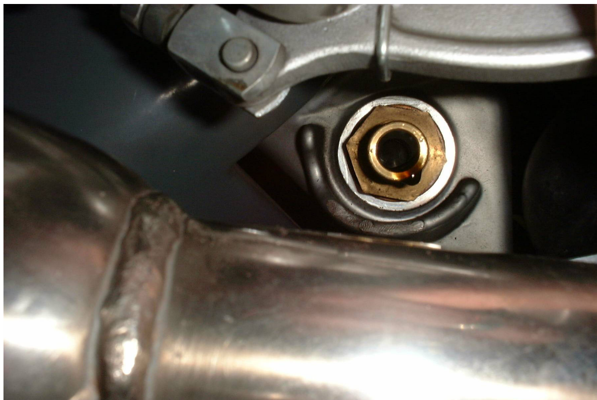
3-2 démonter la crépine une fois le tuyau d'alimentation huile ôté.
