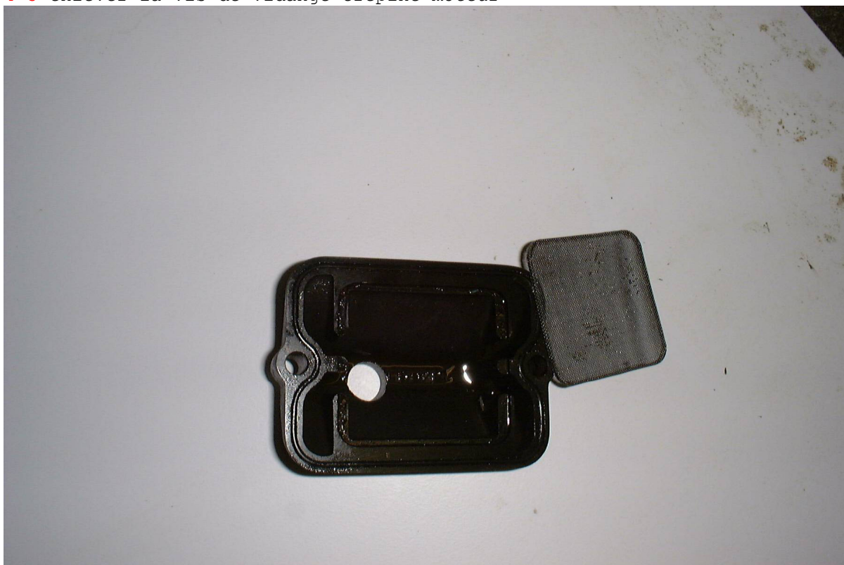
4-4 démonter les deux vis du carter noir et sortir puis nettoyer la crépine moteur (carter de crépine moteur et son tamis filtrant)
