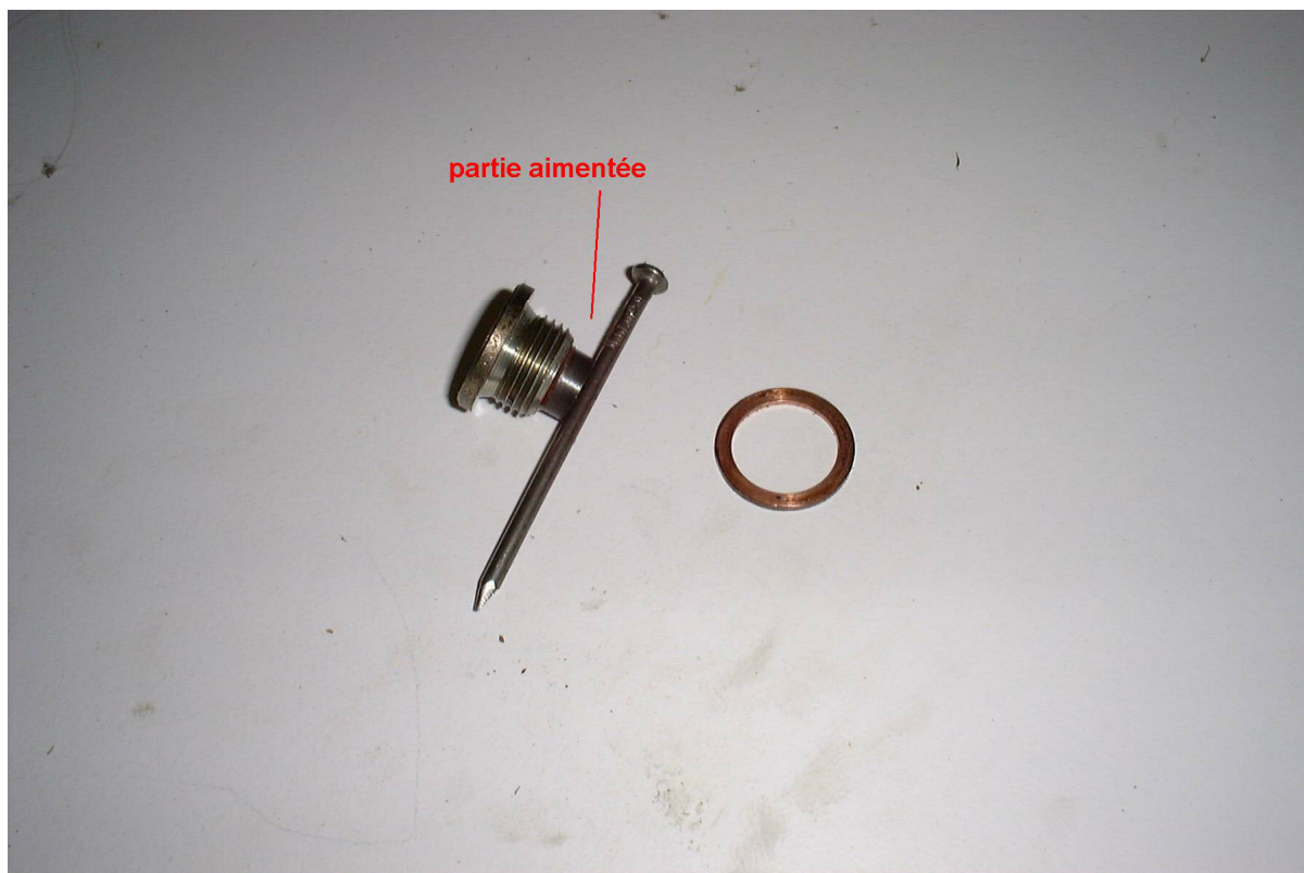
4-3 enlever la vis de vidange crépine moteur
