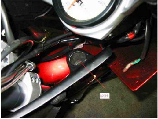
4) mettre en place les silent-blocs dans les deux trous à l'arrière du vase d'expansion et dans le trou libre du contre-carénage (pas celui où vous allez faire passer le goulot de remplissage !) (photo 5).
