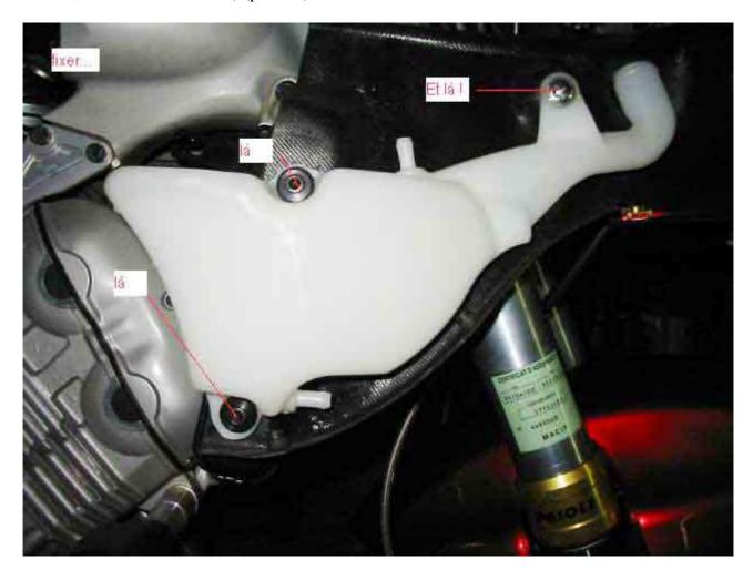
7) poser la durite d'alimentation du radiateur (celle qui a les deux extrémités préformées). Elle relie la prise sous le bouchon du radia (coté Gauche de la moto) au BAS du vase (coté Droit de la moto). Positionner la durit à l'aide de la patte de guidage installé ci-dessus (en 5), prendre soin de la faire passer au large des zones chaudes, faire éventuellement des arrondis et éviter de la pincer. La fixer à chaque extrémité avec les colliers fournis afin d'éviter toute fuite par débranchement.
