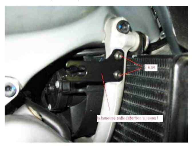
6) fixer le vase (deux vis arrières - les deux longues du kit - prises sur le radiateur et maintenant aussi le contre carénage, ne pas oublier les rondelles, la 3è vis se fixe à même le contre carénage par le trou existant, écrou vers l'extérieur) (photo 7)
