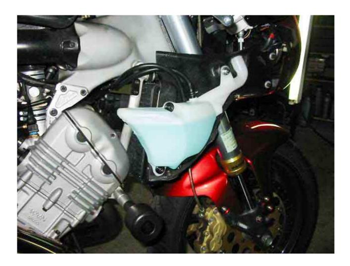
Le kit permet d'embarquer plus de liquide mais ne modifie pas la quantité d'eau utilisée pour le refroidissement.
