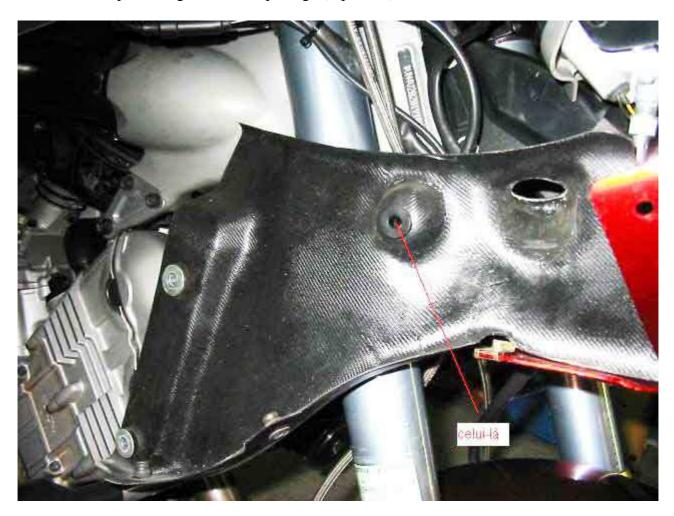
5) mettre en place la patte de fixation sur le support supérieur droit du moteur, avec les 2 vis moyennes du kit (photo 6)
