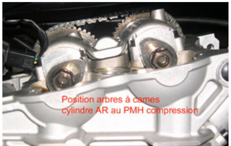
Il faut maintenant recommencer le processus de dépose puis démontage, remontage et repose du tendeur de distribution arrière comme décrit depuis la page 2.
