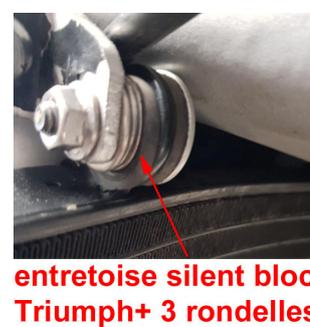
Fixation haute coté gauche avec empilage des 2 silent blocs donnant une épaisseur de 25 mm et vis M6 x 45 mm **repère 3.**
