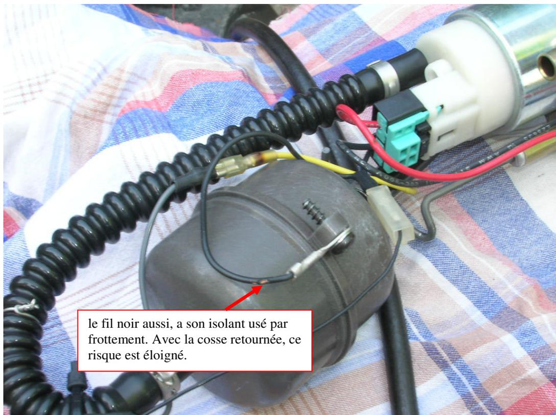
L'isolant pourra être réparé par un gainage du fil à l'aide de gaine thermo-rétractable. Pour plus de sécurité les fils peuvent être changés par des types Alpha Wire Teflon plus résistant avec une meilleure isolation et qui glisse entre eux.
