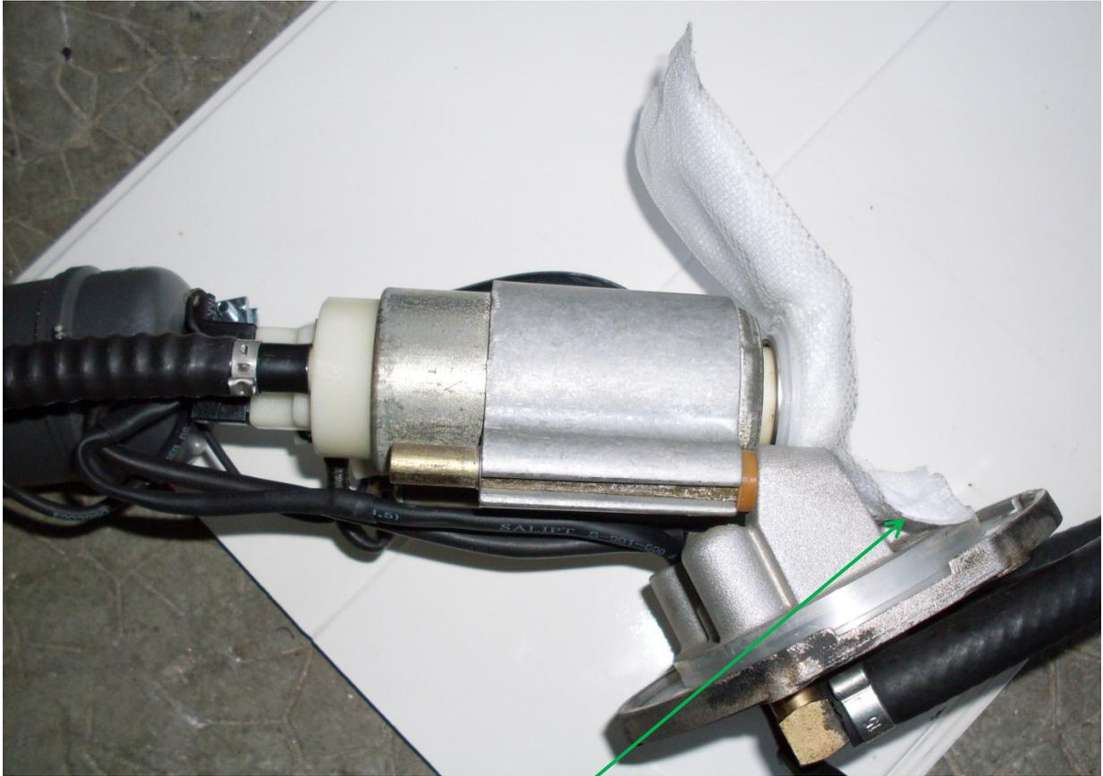
Coin du filtre replié pour éviter qu'il ne vienne sur le plan de joint
