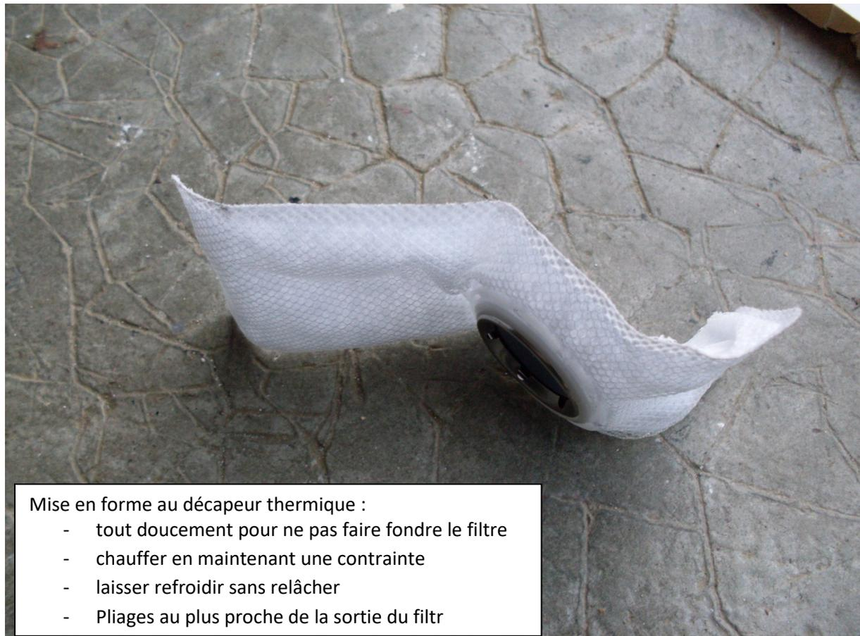
Mise en forme au décapeur thermique :
