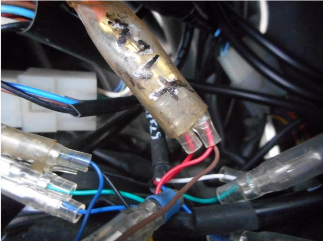
Côté faisceau, le fil d'alimentation est de couleur Orange.(en principe).
