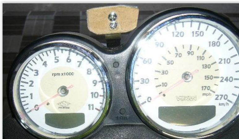
Il reste juste à fixer (double face ou 2 vis) l'afficheur en ayant pris soin de laisser du mou au câble pour les mouvements de la colonne de direction.
