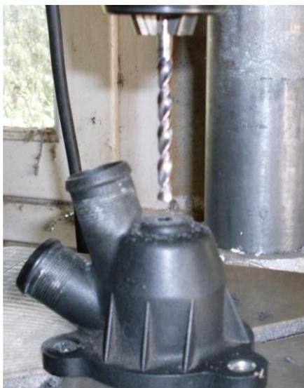
**Percer bien au centre du bossage**, car cela permet l'installation d'un écrou nylstop depuis l'intérieur si le taraudage devait venir à foirer lors d'un changement de sonde (vécu...)
