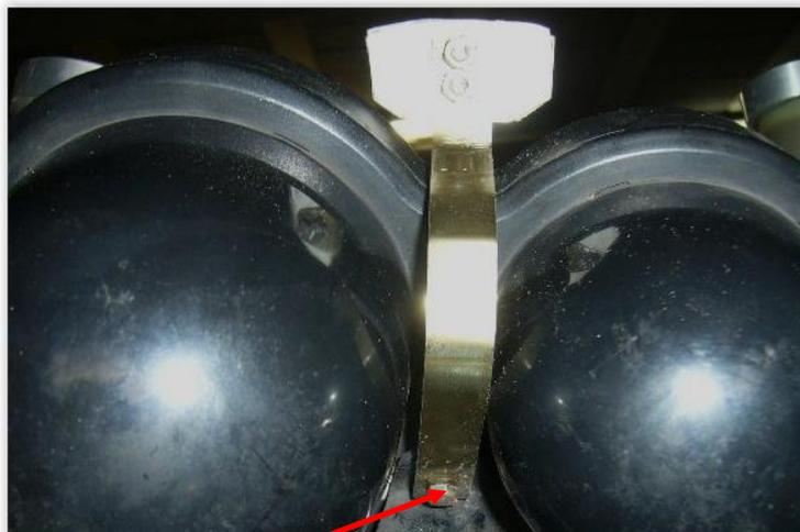
Patte fixée sur la vis d'origine du tableau de bord
