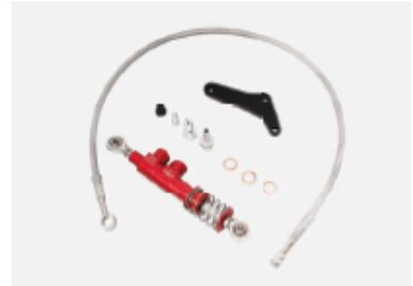
Y-a plus qu'à monter ! Pour l'étrier c'est facile, c'est du plug & play. En ce qui concerne le MC il y a un peu plus de boulot. La rotule inférieure frotte sur le silencieux TCS, ce n'était pas prévu. Avec les échappements d'origine ça doit passer.
