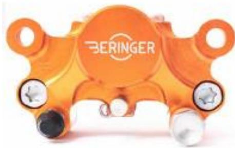
Donc, pour en revenir, j'ai commandé un kit qui comprend le MC, la platine, la durite et un kit de raccordement. Pour faire bonne figure, un étrier double pistons oppose complète la panoplie
