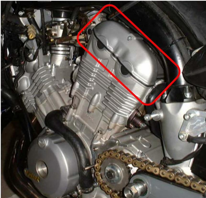
→ Il suffit de décaler un peu le faisceau élec et d'un peu de doigté pour sortir le couvercle culasse sans démonter le tube de cadre
